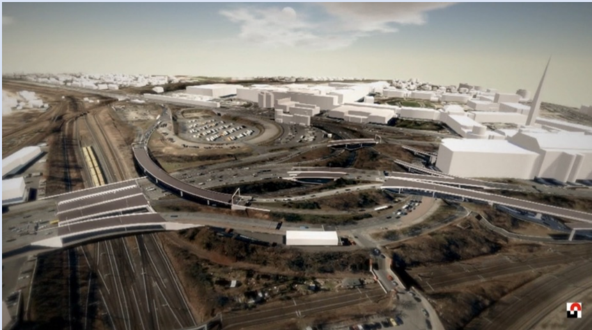
Abbildung 2: Dreidimensionale Darstellung der Planungen für das Autobahndreieck Funkturm anhand eines digitalen Modells (Quelle: DEGES)
